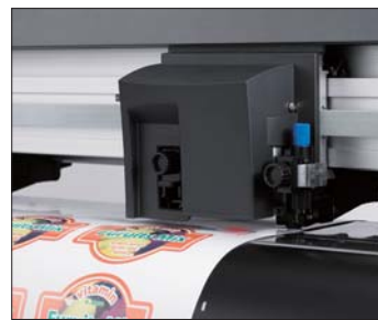
Système de repérage automatique ARMS 4.0
